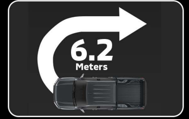
រង្វង់កង់បត់ក្រចករូបក្រោយត្រឹមតែ 6.2 ម៉ែត្រ
