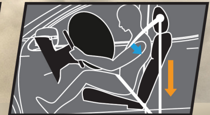
ប្រព័ន្ធលែងក្តិនខ្សែក្រវាត់ក្នុងពេលប៉ះទង្គិច
