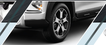
យ៉ាន់កង់អាលុយមីញ៉ូម 17 អ៊ីញត្រូវបានចង្ហិន
